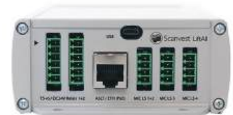
Abmessungen (BxHxT): 105 x 45 x 197 mm
