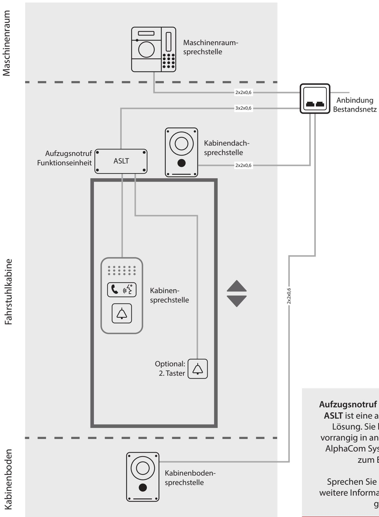
**Aufzugsnotruf Classic ASLT** ist eine analoge Lösung. Sie kommt vorrangig in analogen AlphaCom Systemen zum Einsatz.
