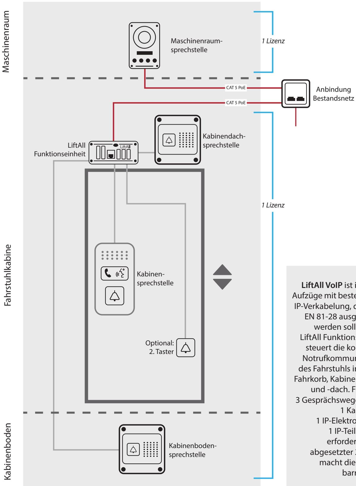
**LiftAll VoIP** ist ideal für Aufzüge mit bestehender IP-Verkabelung, die nach EN 81-28 ausgestattet werden sollen. Eine LiftAll Funktionseinheit steuert die komplette Notrufkommunikation des Fahrstuhls inklusive Fahrkorb, Kabinenboden und -dach. Für diese 3 Gesprächswege ist nur 1 Kabelweg, 1 IP-Elektronik und 1 IP-Teilnehmer erforderlich. Ein abgesetzter 2. Taster macht die Lösung barrierefrei.
