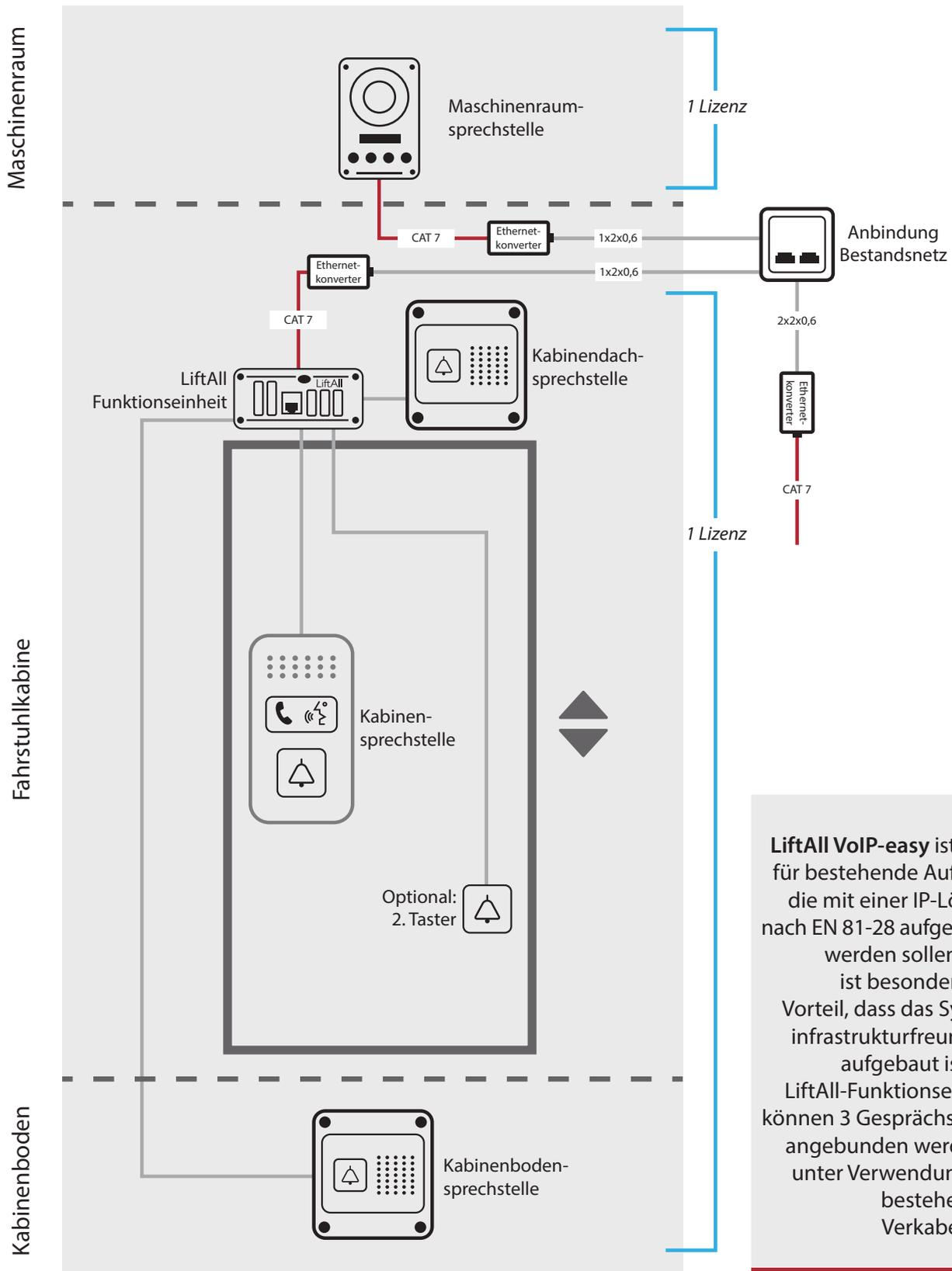
**LiftAll VoIP-easy** ist ideal für bestehende Aufzüge, die mit einer IP-Lösung nach EN 81-28 aufgerüstet werden sollen. Hier ist besonders von Vorteil, dass das System infrastrukturfreundlich aufgebaut ist: Pro LiftAll-Funktionseinheit können 3 Gesprächswege angebunden werden – unter Verwendung der bestehenden Verkabelung.
