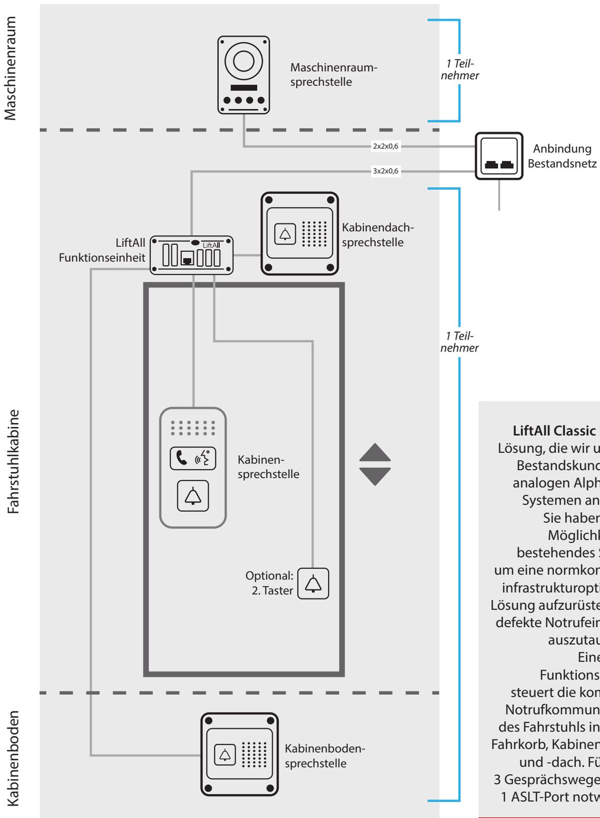
**LiftAll Classic** ist eine Lösung, die wir unseren Bestandskunden mit analogen AlphaCom-Systemen anbieten. Sie haben so die Möglichkeit, ihr bestehendes System um eine normkonforme, infrastruktoptimierte Lösung aufzurüsten bzw. defekte Notrufeinheiten auszutauschen. Eine LiftAll Funktionseinheit steuert die komplette Notrufkommunikation des Fahrstuhls inklusive Fahrkorb, Kabinenboden und -dach. Für diese 3 Gesprächswege ist nur 1 ASLT-Port notwendig.
