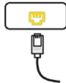
Dank Power over Ethernet (PoE) können unsere IP-Lautsprecher nahtlos an Standardnetzwerke für Strom, Daten und Audio angeschlossen werden. Durch den außenliegenden Ethernetanschluss wird die Installationszeit erheblich verkürzt, da man das Gehäuse für die Installation nicht öffnen muss.
