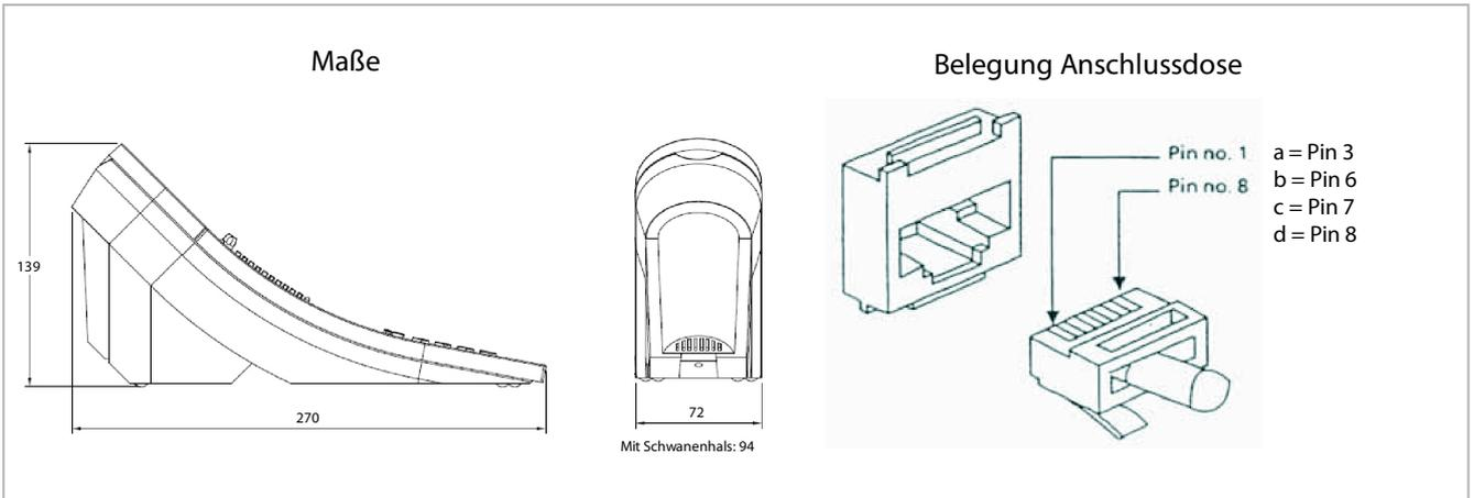
Hinweise: Die Belegung der RJ45-Buchse am Gerät ist: a = 2, b = 5, c = 6, d = 7.
