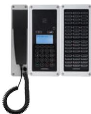
Das **IP-Leitstandterminal** verfügt über eine umfangreiche Anzeige und bis zu 100 DAK-Tasten, die jede beliebige Funktion erfüllen können, z.B. als Zustandsindikator jeder IP-Sprechstelle (OK, Störung, Ruf etc.)
