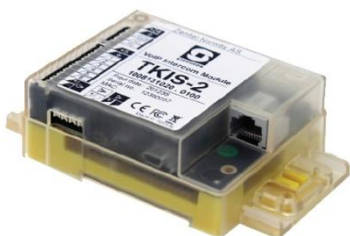
VoIP-Intercom-Modul TKIS zur Überwachung der Funkbaugruppen
