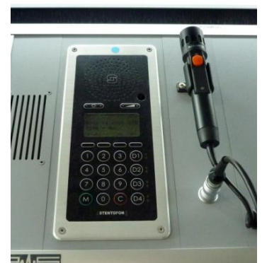
Leitstandsprechstelle mit externem Mikrofon
